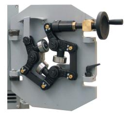
Fig. 14: Triple roller guide
